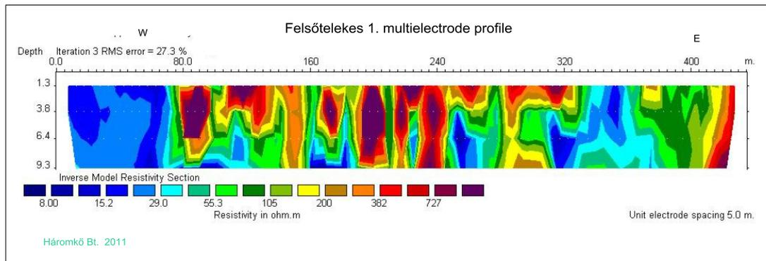
Figure 5. Multielectrode section at Felsőtelekes
