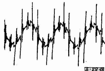
15. ábra. Fázisfeszültség időfüggvénye motoros üzemmódban, fojtótekerics nélkül
