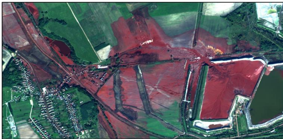
1. kép: Hiperspektrális felvétel a sérült tározó területéről látható szintartományban megjelenítve
