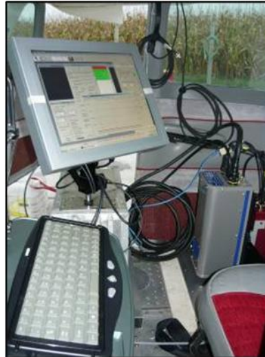
5. kép: AISA Eagle II hiperspektrális szenzor és fedélzeti rendszer repülőgépbe beszerelve
