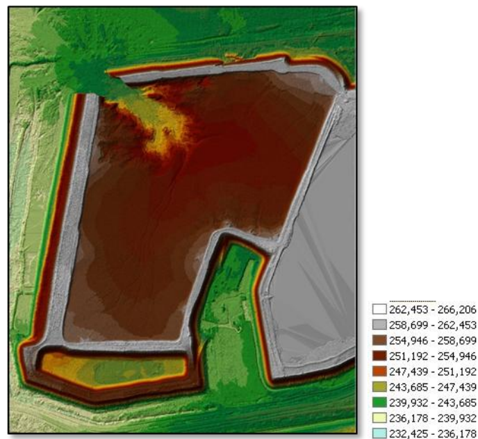
4. kép: A LIDAR pontfelhő alapján készített digitális terepmodell a sérült tározóról (mBf)
